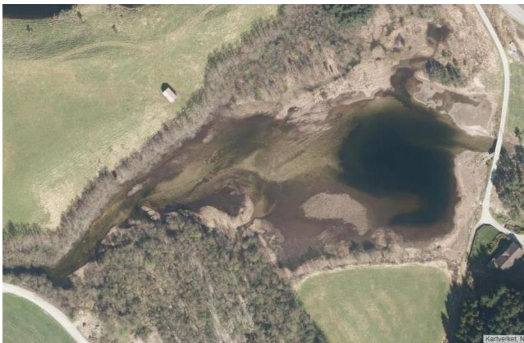
Figur 35. Flybilde «Strand 2012». Ved utløpene av Regnåna er mindre finstoff å se, men det er store mengder generelt i Floen. Slik de lyse feltene ligger i løpet ser det ut som tilførselen kommer fra øvre del av Bleiåna. Usikkerhet rundt vannføring gir usikkerhet i vurderingen. Tidspunktet er midt i tunnelbyggingen som ble nevnt som en synlig forurensningskilde (pers.medd. Jan Lie).
